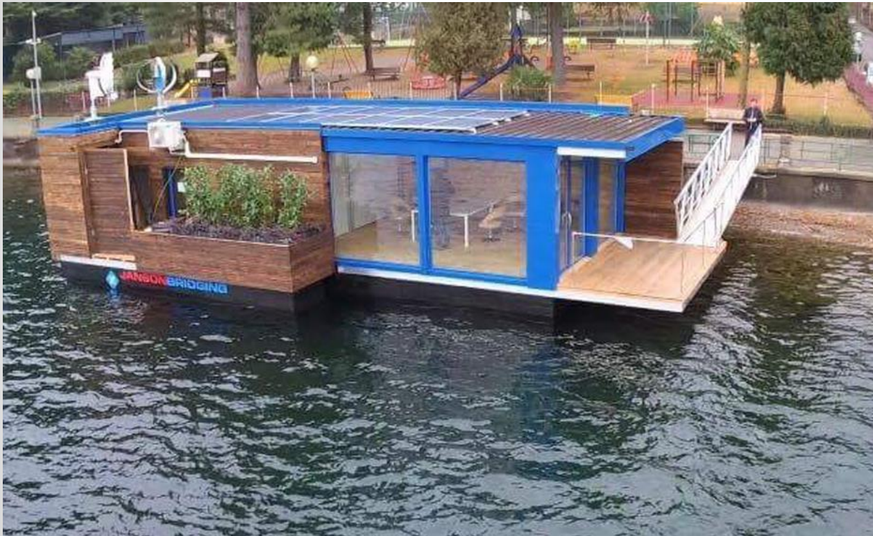
Botel 2.0 installazione di struttura galleggiante autonoma con fonte eolica e fotovoltaica presso Porto Ceresio
