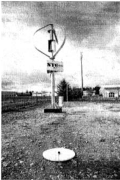
Abbildung 1: Blick entgegen der Richtung des Windes auf den Rotor. Vorne Turmfuß entfernt das Messmikrofon auf einer schallharten Platte. In Blickrichtung Rotor wird in 10 m Höhe über dem Erdboden die Windgeschwindigkeit gemessen. Die Änderung der Windrichtung wird mit Hilfe eines Windsacks elektrische Leistung wird nach der Anlagenkennlinie ins Netz eingespeist.
